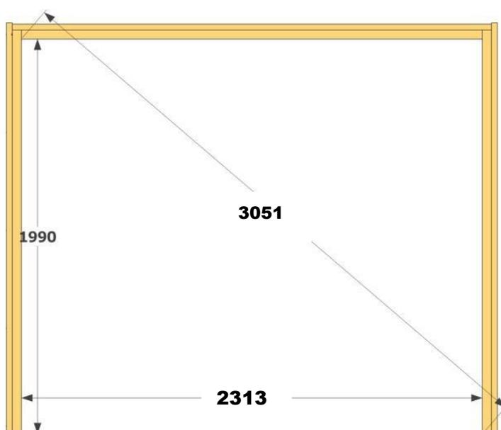
Montera ytterfodren 15mm ut från innerkanten på karmen. Nedre foderbrädan monteras jämnas med golvet. Skruva enbart i karmen förutom de skruvar som sitter i nedre väggbrädan. Där kan man skruva i väggen också. Läs sedan medföljande instruktioner från leverantören av glaspartiet för montering av detta.
