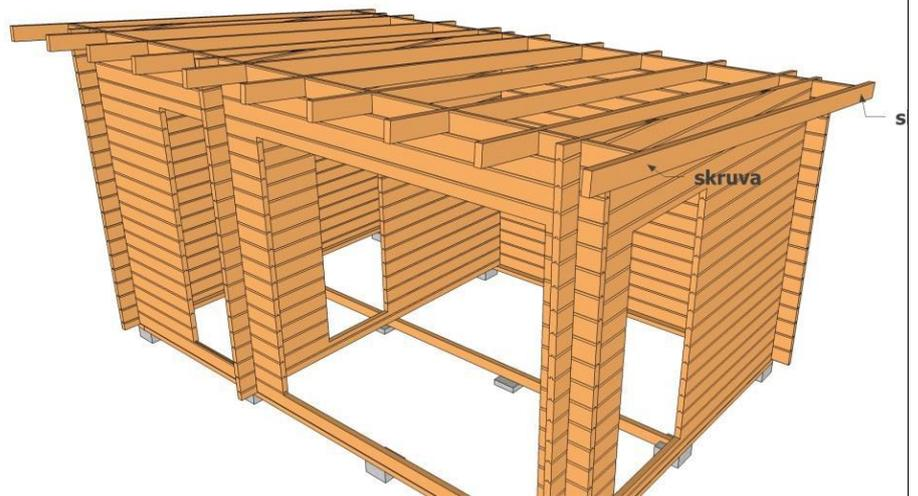
Montera taket. Lägg bräderna med finsidan inåt. Takbräderna är ändspontade för att vara enkla att skarva. Försök att få skarvarna förskjutna och ej bredvid varandra. Det går bra att skarva mellan takåsarna.
