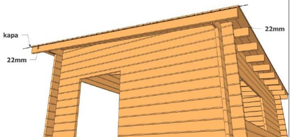
Montera de nedre vindbrädorna. Dra ner den ca 10mm under takåsen. Skruva i takåsen.
