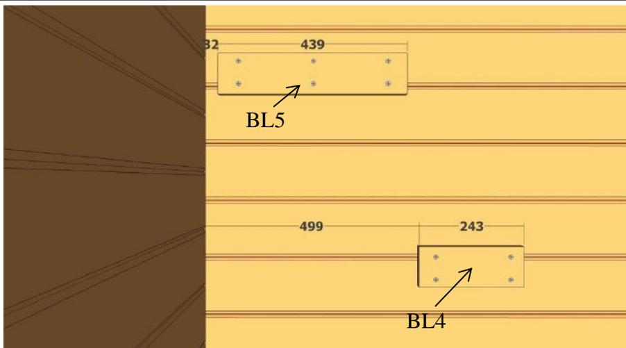
Lägg upp bastulavarna på konsolerna och kapa till en stödkloss på ca 10cm ur medföljande 45x95 regel BL5.
