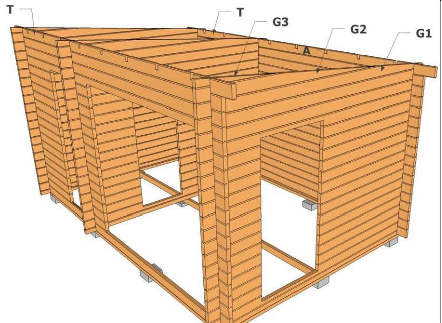
Lägg i takåsar i urtagen på i T-bräderna. Det längre takutsticket ska vara mot framsidan. De två yttre takåsarna utan urtag skruvas längst ut i T-bräderna.
