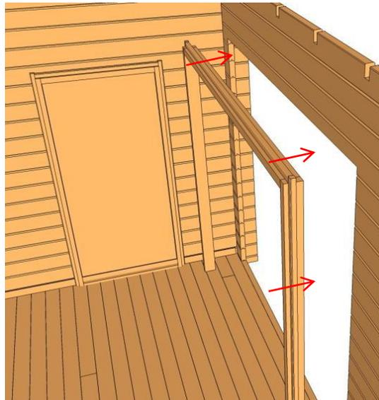
Använd träkilar för att centrera och stabilisera ramen. Skruva endast i den nedre väggbrädan.
