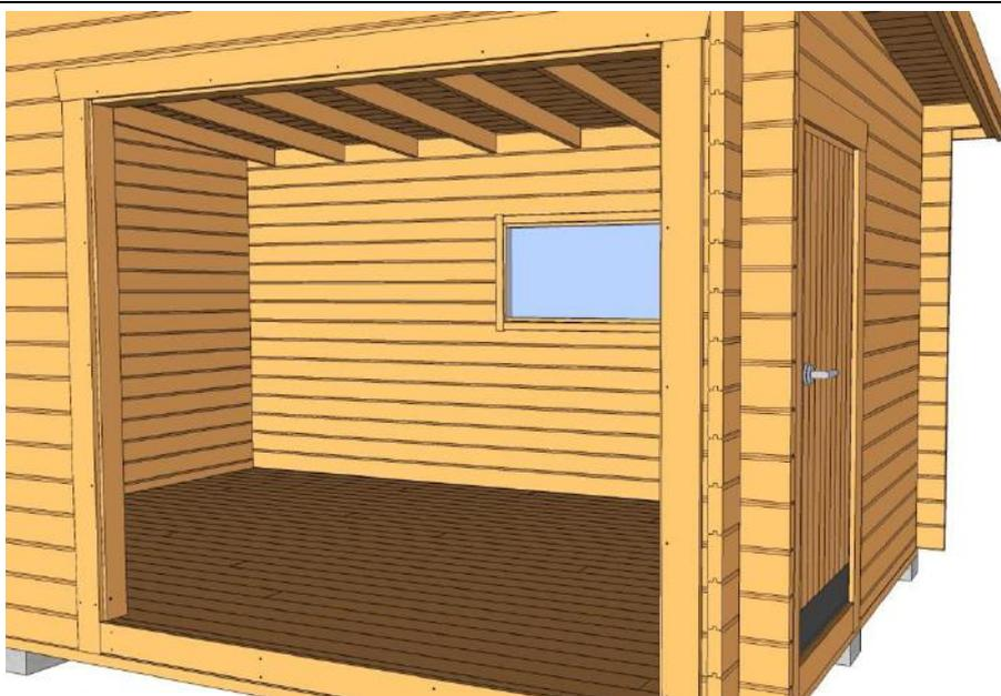
Montera golvlisten och dropplåten under glaspartiet. Klipp till plåten i ändarna efter önskemål och stick in plåten under golvskenan och skruva/spika i fodret under öppningen.
