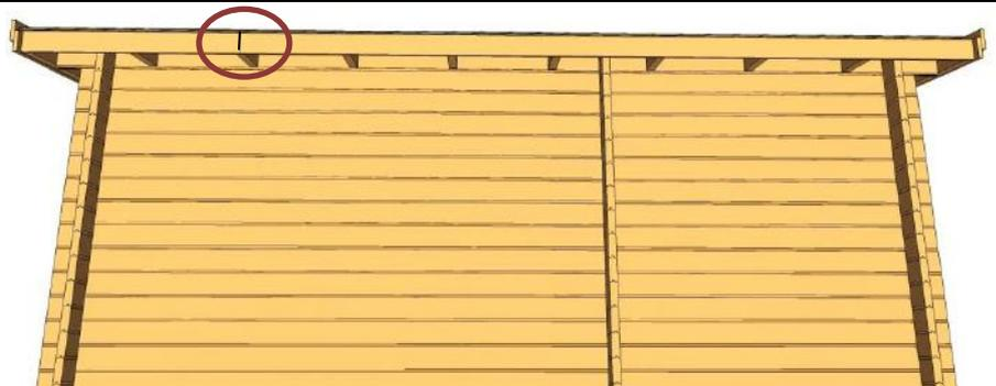
Kapa till de övre takfotsbrädorna. Dessa ska monteras med överkant jäms med taket. Skruva i nedre takfotsbrädan och i takbrädorna.
