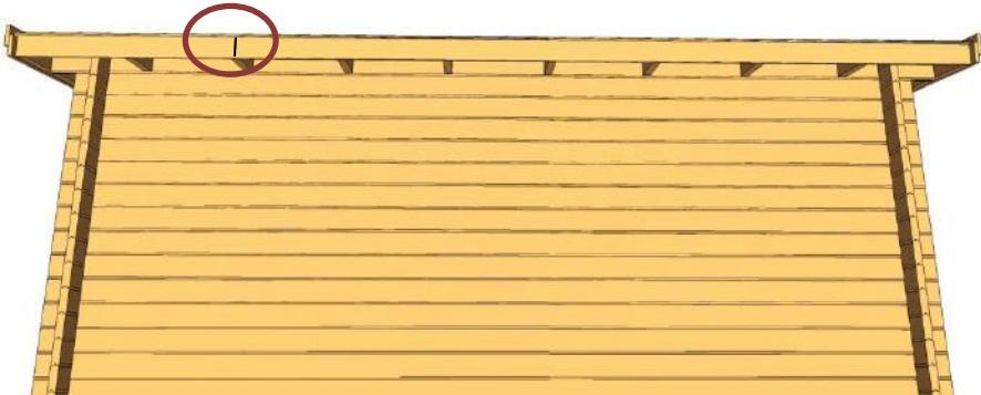
Kapa till de övre takfotsbrädorna. Dessa ska monteras med överkant jäms med taket. Skruva i nedre takfotsbräden och i takbrädorna.
