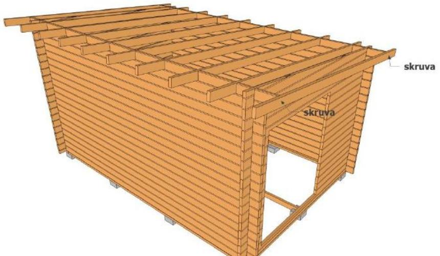
Montera taket. Lägg brädorna med finsidan inåt.
