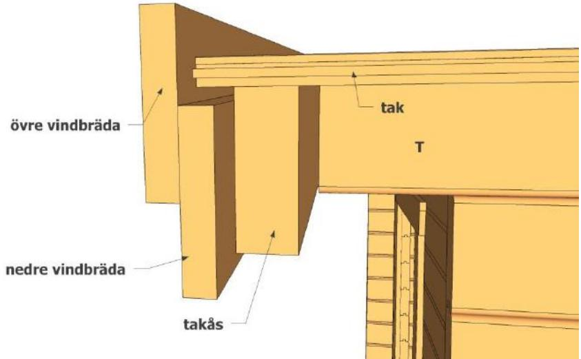
Mäta och kapa till de nedre takfotsbrädorna. De monteras jäms med underkant på de nedre vindbrädorna. Skruva i takåsarna.
