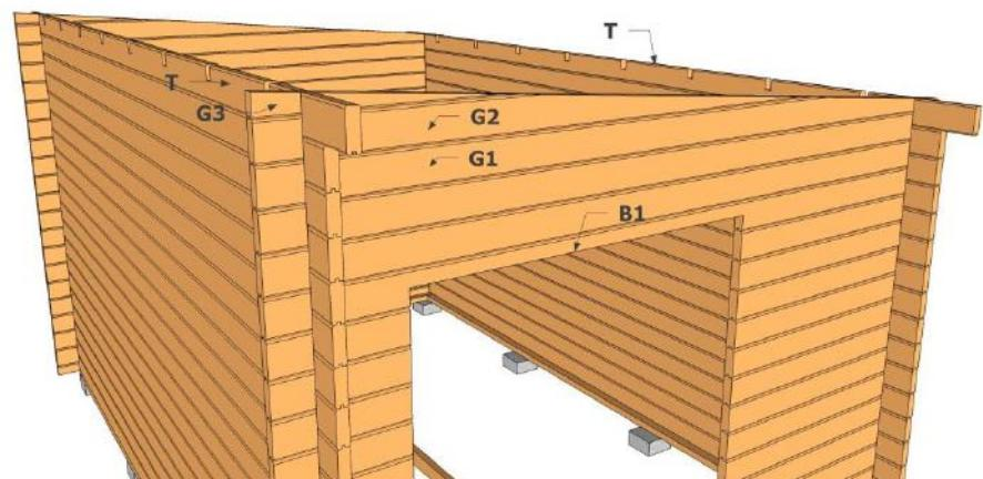
Lägg i takåsarna i urtagen på i T-brädorna. Det längre takutsticket ska vara mot framsidan. De två ytterna takåsarna utan urtag skruvas längst ut i T-brädorna.
