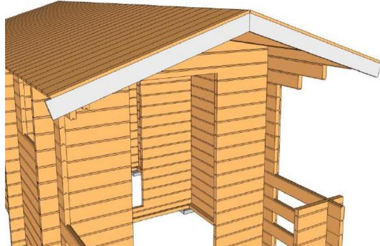
Skruga fast de övre vindbrädorna. Förskjut vindbräden ca 5-7cm uppåt.
