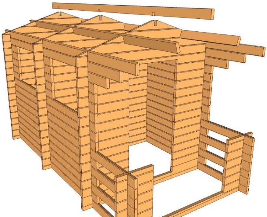
Montera taket. Lägg brädorna med finsidan inåt.
