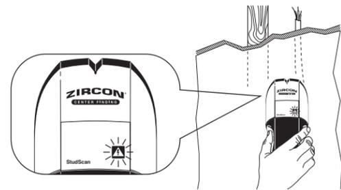
*Nota: El instrumento puede detectar otros objetos detrás de la pared como tubos y conducto. Vea la Sección 2: CONSEJOS DE FUNCIONAMIENTO para modos de confirmar que usted encontró una viga.*
