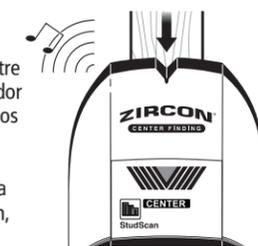
En los casos donde existen vigas muy profundas (paredes más gruesas), cuando se encuentra el centro de la viga sólo dos barras del Indicador de Potencia de Señal se mostrarán y sólo el haz de luz, el indicador de Centro, y algunos segmentos de las barras de indicación de Objetivo se iluminarán. Si todavía no puede localizar una viga, pruebe el próximo paso.
