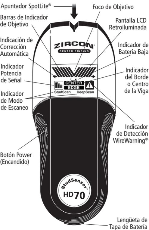
El StudSensor™ HD70 OneStep® Zircon detecta el centro y bordes de vigas en paredes, pisos, y techos en un paso. Cuenta con una pantalla retroiluminada de color azul, foco de objetivo, y una luz tipo puntero patentado. La detección automática WireWarning® detecta y también lo alerta de la existencia de cables vivos con corriente AC.
