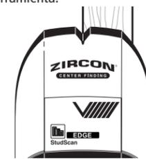
Continúe deslizando la herramienta. Cuando el centro de la viga se encuentre con tres barras en el Indicador de Potencia de Señal, algunos segmentos de las barras de indicación del Objetivo, el indicador de CENTRO, y la luz indicadora se iluminarán, y la bocina sonará.
